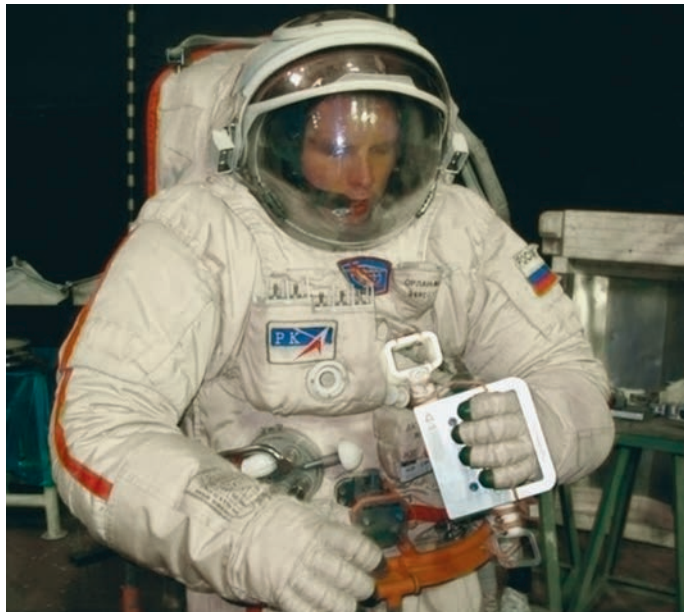
Испытатель в скафандре "Орлан" проводит наземную эргономическую оценку прибора "Тест". Фото З.В. Цыганковой.
